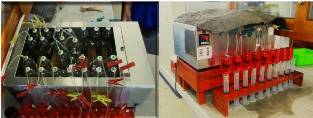
Figura 2. Sistema de producción de gas *in vitro*.
